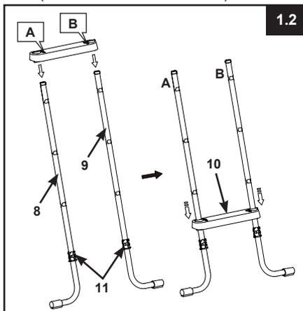
**WICHTIG:** Versichern Sie sich, dass die J-förmigen FüÙe nach auÙen schauen, bevor Sie die Stufen montieren.
