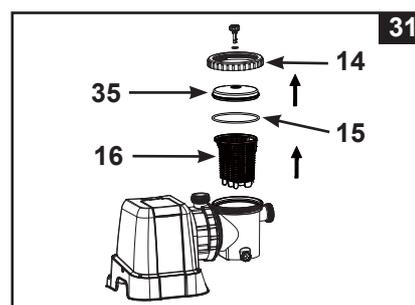
5. Leeren Sie den Korb und spülen Sie ihn mit einem Gartenschlauch aus, benutzen Sie eine Plastikbürste um gegebenenfalls Ablagerungen aus dem Korb zu entfernen. Verwenden Sie keine Metallbürste.
