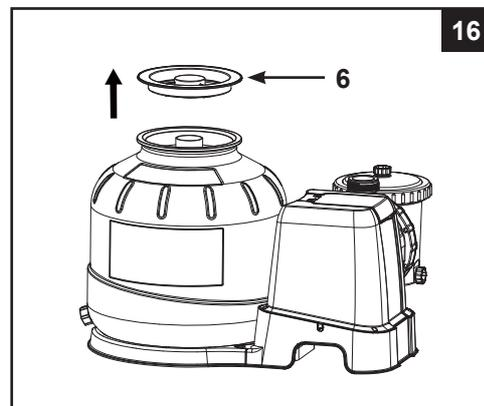
3. Verteilen Sie den Sand gleichmäßig im Behälter und füllen Sie etwas Wasser in den Behälter um einen dämpfenden Effekt zu erreichen, wenn der verbleibende Sand eingefüllt wird. Das verhindert, dass das Mittelrohr (7) einen zu starken Stoß bekommt (siehe dazu Zeichnung 17). Dann geben Sie das Sandschild (6) wieder auf den Tank und befüllen Sie den Tank mit dem restlichen Sand.
