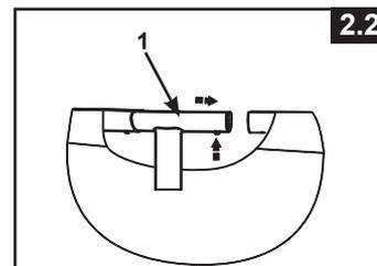
Die letzte Verbindung kann schwer zu bewerkstelligen sein. Es geht jedoch leichter, wenn Sie zuerst das letzte Verbindungsstück und die Stange gleichzeitig um ca. 5 cm anheben. Nun stecken Sie die Stange ins Verbindungsstück während Sie die Teile absenken. Die Stange wird leicht ins Verbindungsstück gleiten (siehe dazu Zeichnung 2.3). Bevor Sie mit dem Zusammenbau der Steher weitermachen, vergewissern Sie sich, dass das letzte Verbindungsstück vollständig zusammengesteckt ist.
